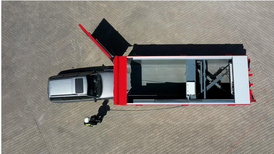
Variabel verschiebbare Wand zur Ladungssicherung und für einen effizienten Einsatz der einzusetzenden Löschmittel.
