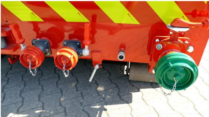
2 B-Füllstutzen, CO2-Anschluss, 1 A-Saugstutzen
