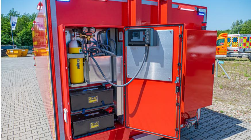
Hydrauliksteuerung und Steuerung der Dichtungen über kabelgebundene Fernbedienung, Befüllung der Dichtung automatisiert über Druckluftflasche
