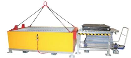
HV Batterie Zerlegetisch mit Kühlbecken
